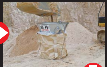
②バケツで「瞬作」に土砂を入れる
